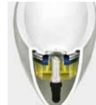
Das Herzstück der uridan®-Urinale ist dabei der patentierte uridan®- Geruchsverschluss: Er funktioniert mit uriLOCK®, einer speziellen Sperrflüssigkeit. Sie besteht aus rein pflanzlichen Stoffen und ist biologisch abbaubar. Da sie leichter als Urin ist, fließt der schwere Urin automatisch direkt in die Kanalisation. Das leichtere uriLOCK® bleibt an der Oberfläche und wirkt wie ein flüssiger Deckel, der alle Gerüche aus dem Kanal fernhält.
