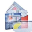
Strisce di misurazione del cloro e del valore di pH.
