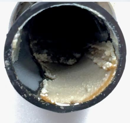
Ein WC-Spülkasten arbeitet im Verborgenen – und genau deshalb wird er oft vergessen. Doch im Laufe der Zeit lagern sich im Inneren Kalk, Schmutz und Rückstände aus dem Leitungswasser ab. So kann sich nicht nur der Spülkasten sondern auch der Spülbogen, die Verbindung zur Toilette, mit Kalk und Schmutz zusetzen. Besonders in Regionen mit hartem Wasser kann das zu spürbaren Problemen führen:
