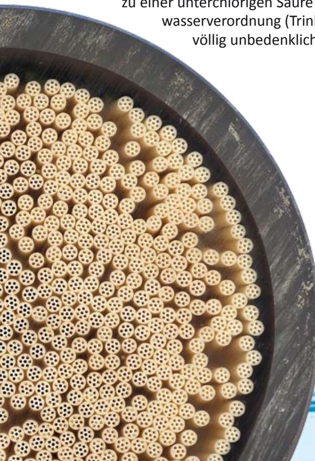
*Ein Ultrafiltrationssystem hält alle Mikroben und Schwebeteilchen mit mehr als 0,03 µm Durchmesser zurück, sodass sie nicht wieder ins Trinkwasser gelangen.*
