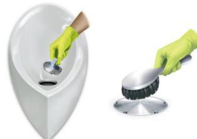
» Alle **2 Wochen** den Deckel entfernen und reinigen sowie den Hals und Rand des Urinals mit einer Bürste säubern.
