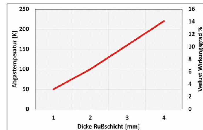
Der Gesetzgeber legt im Gebäudeenergiegesetz u.a. die regelmäßige Reinigung und Wartung durch Fachkräfte fest (§ 60 GEG). Eine gewartete Anlage punktet nicht nur mit einem höheren Wirkungsgrad, wirtschaftlicherem Betrieb und niedrigeren Heizkosten, sondern auch mit einer geringeren Umweltbelastung – weniger Rohstoffverbrauch, niedrigeren Abgastemperaturen.
