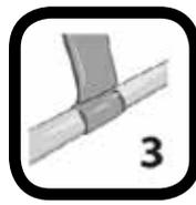
Dehnen Sie das **SANIT SHK-Tape** (mind. 2 fache) und wickeln Sie es um den zu reparierenden Gegenstand. Die erste und letzte Umwicklung sollten komplett überlappen.
