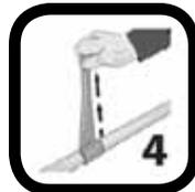
Dehnen Sie das Band konstant während dem Wickeln und vergewissern Sie sich, dass das Band immer zur Hälfte überlappt.
