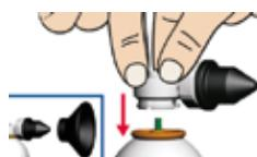
2. Schütteln Sie die Dose kräftig vor dem Einsatz. Drehen Sie die Dose auf den Kopf (Sprühkopf nach unten). Drücken Sie den Sprühkopf des Adapters in eine Düse. Sprühknopf drücken, bis das System vollständig ausgeschäumt ist. Benachbarte Düsen zuhalten. Vorgang bei mehreren Düsen wiederholen.
